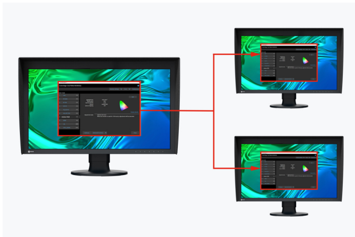
Kalibrierungsdaten werden im Monitor gespeichert
