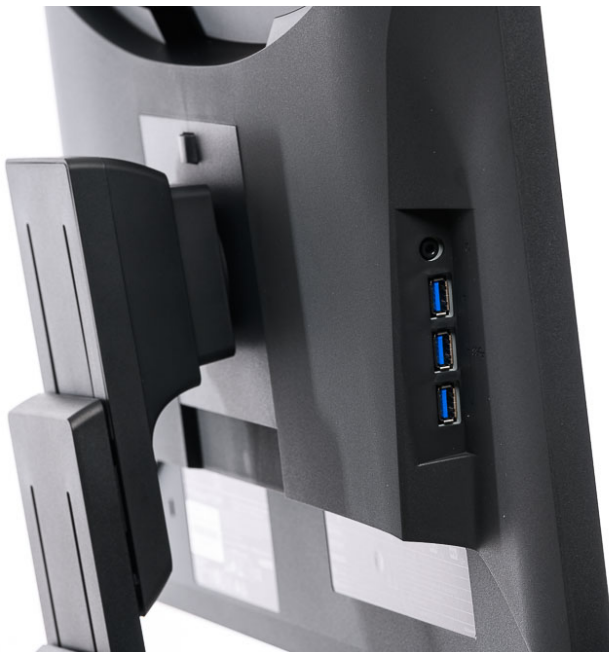
3 x USB-3.0-Downstream-Ports und die Kopfhörerbuchse seitlich im Erker
